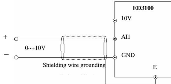
**Fig.3-8 AI1 Terminal wiring**
